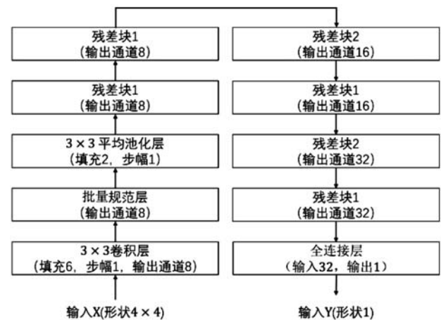
图2 基于 ResNet 的大坝变形预测模型结构
